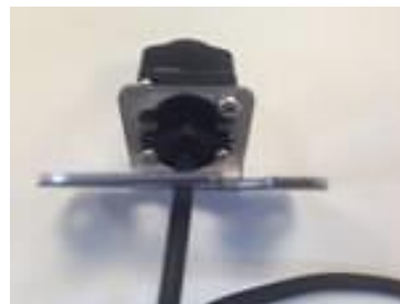
Камера повернута на монтажном кронштейне на 180°
